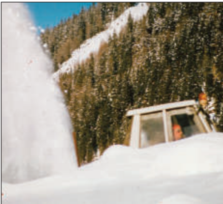
Im Winter 1969/70 übernahm die Gemeinde Außervillgraten unter BM Perfler Michael zum ersten Mal die Schneeräumung im ganzen Gemeindegebiet. Eingesetzt wurde ein Steyr Traktor 650A mit vollhydraulischem S.nschneepflug, Wohllaib S.nwallschleuder und einer Frontladerschneeschaufel auf drei S.n zu kippen.
